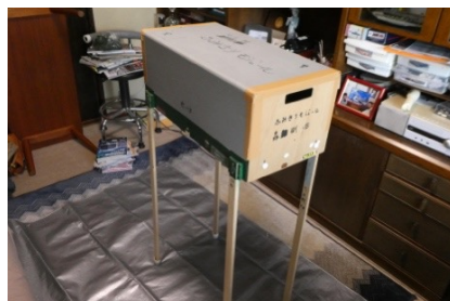
④モジュールを立ててからカバーを外す。情景を壊さずにモジュールの組み立てができる。
