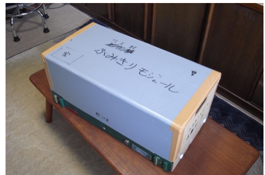
②樹脂板を貼って完成。(段ボールを貼こともある) 両端の板は台枠にねじ止めし、しっかりと固定できるようになっている。
